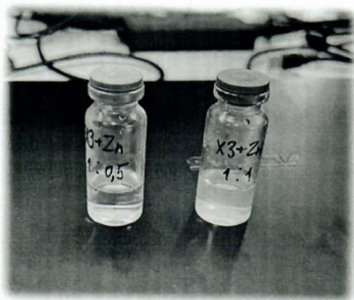
Рис. 5. Образцы X3 1:1 Zn и X3 1: 0.5 Zn через 20 минут после начала смешивания растворов хитозана и сульфата цинка
