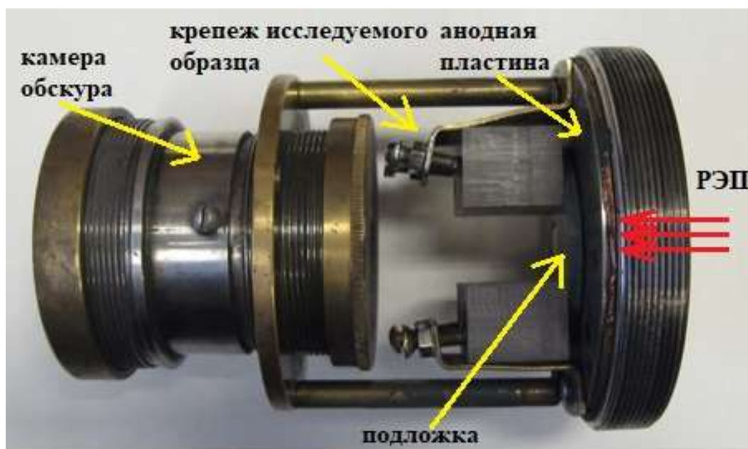
Рисунок 19. Конструкция диодного узла
