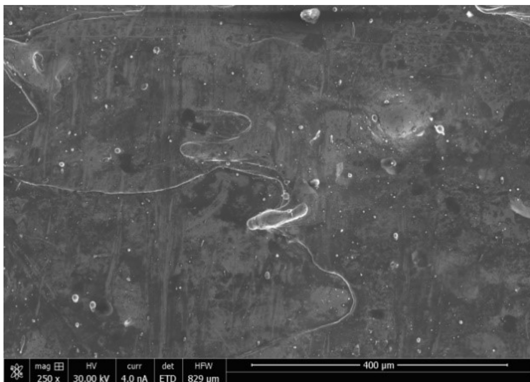
Рисунок 28. Микрофотография образцов ЭК-181 после 3-кратного облучения
