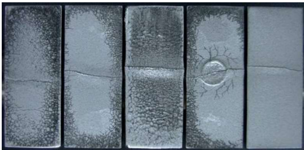
Рисунок 6. Фотография моноблоков вольфрама ITER-grade марки A.L.M.T. Corp. после плазменно-тепловых испытаний в плазменной пушке и электронным пучком. На поверхности образуются большие трещины
