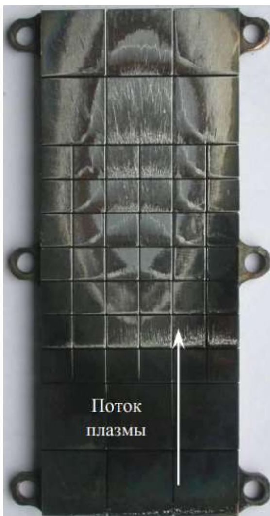
Рисунок 4 Испытание вольфрама в КСПУ-Т при нагрузке 1,6 \text{ МДж} \cdot \text{м}^{-2} (эквивалентно воздействию срыва в ИТЭР), 100 импульсов
