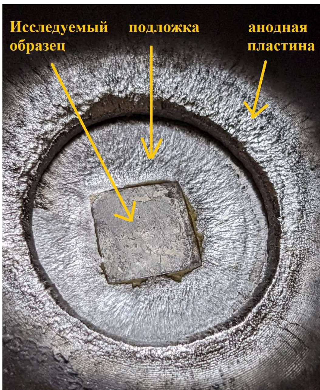
Рисунок 22. Способ крепления исследуемого образца
