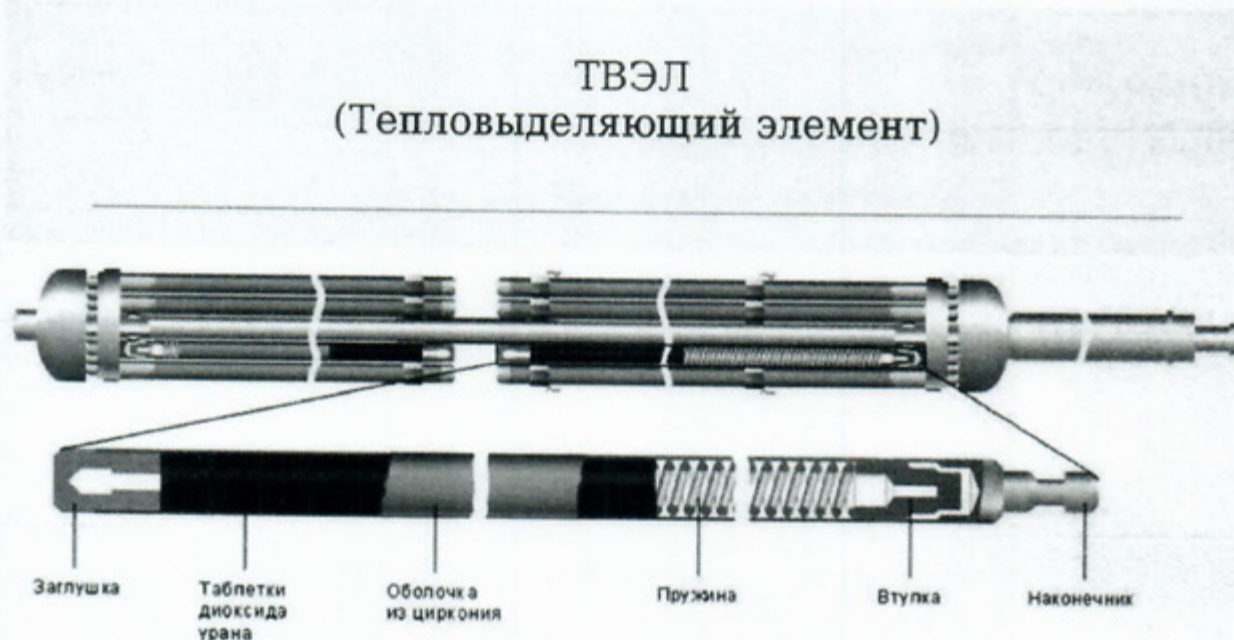
Рисунок 1.11. Тепловыделяющий элемент
