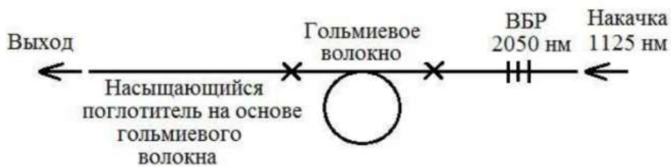
Рисунок 12. Гольмиевый волоконный лазер с модуляцией добротности.
